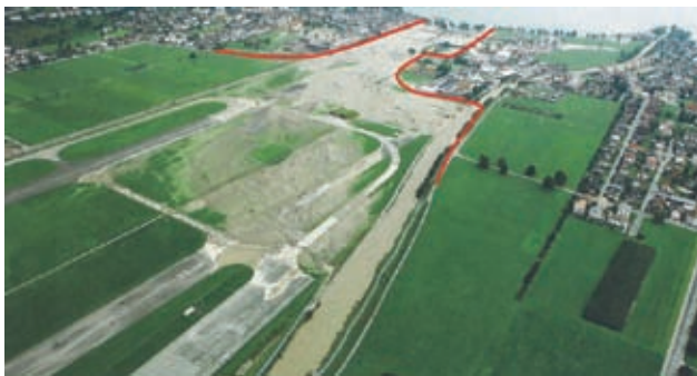
Abb. 23: Berücksichtigung des Überlastfalles: Dank einem Überlastungskorridor, der Wasser aus der hochgehenden Engelberger Aa bei Hochwasser gezielt über den Flugplatz in den Vierwaldstättersee ableitet, blieb Buochs NW (rechts) im August 2005 vor Überschwemmungen verschont. Ennetbürgen NW (links) wurde teilweise überflutet, weil der inzwischen bestehende Schutzdamm – wegen Projektverzögerungen – damals noch nicht fertig gestellt war.
