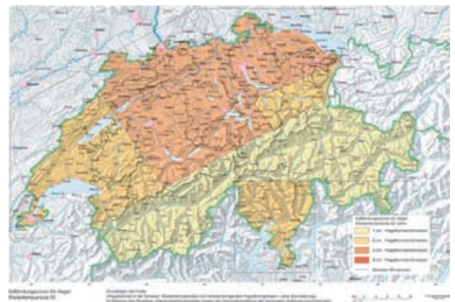
Abb. 34: Gefährdungszonen für Hagelkorngrössen mit einer Wiederkehrperiode von 50 Jahren (Präventionsstiftung der Kantonalen Gebäudeversicherungen).
